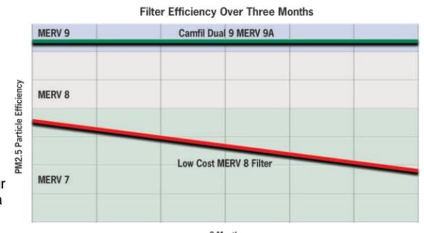
L'espace entre les lignes d'efficacité correspond aux particules qui passent au travers du filtre et qui sont collectées par les filtres secondaires, les serpentins de chauffage et de refroidissement, faisant ainsi obstacle à une opération de ventilation efficace.
